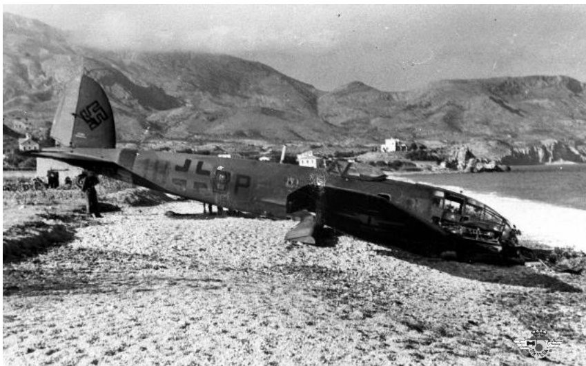
El Heinkel He 111H-11 W.Nr.8392, 1H+BP, posado en la playa con el tren plegado. (IHCA)
